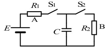
スイッチ  $S_1$  を閉じた。電荷の移動には時間がかかるので, スイッチを閉じた瞬間, コンデンサーに電荷は蓄えられていない。ゆえにコンデンサーの極板間の電圧は[ ア ][V]である。したがって, 抵抗 A の両端の電圧は[ イ ][V]となり, 流れる電流  $I_0$  はオームの法則より[ ウ ][A]である。
