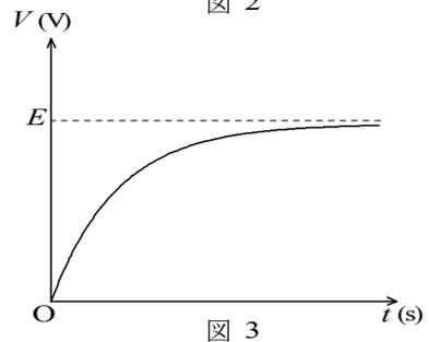
問2. 時刻  $t$  のとき、コンデンサーに蓄えられた電荷が  $q$  であったとする。コンデンサーの極板間の電圧  $V$  は  $V = \frac{q}{C}$  であり、これが抵抗  $B$  の両端の電圧でもある。ゆえに流れる電流  $i$  は
