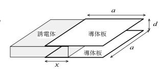
この状態からさらに  $\Delta x$  だけ誘電体を挿入する。 ただし,  $\Delta x$  は x, a に比べて十分に小さいものとする。
